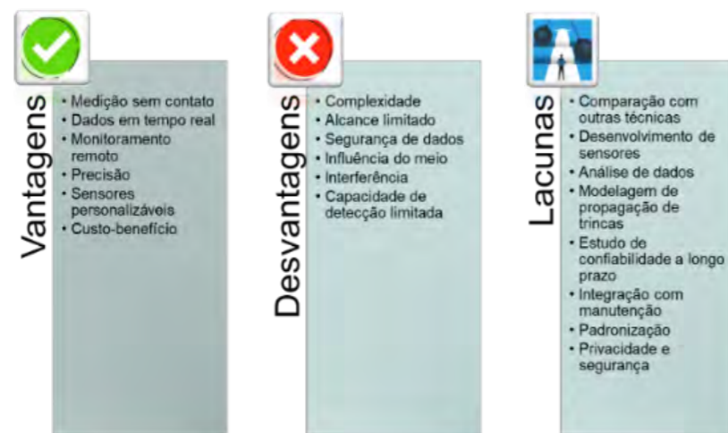
Figura 2 – Vantagens, desvantagens e lacunas para a utilização do RFID em esteiras transportadoras. Fonte: Elaborado pelos autores.
