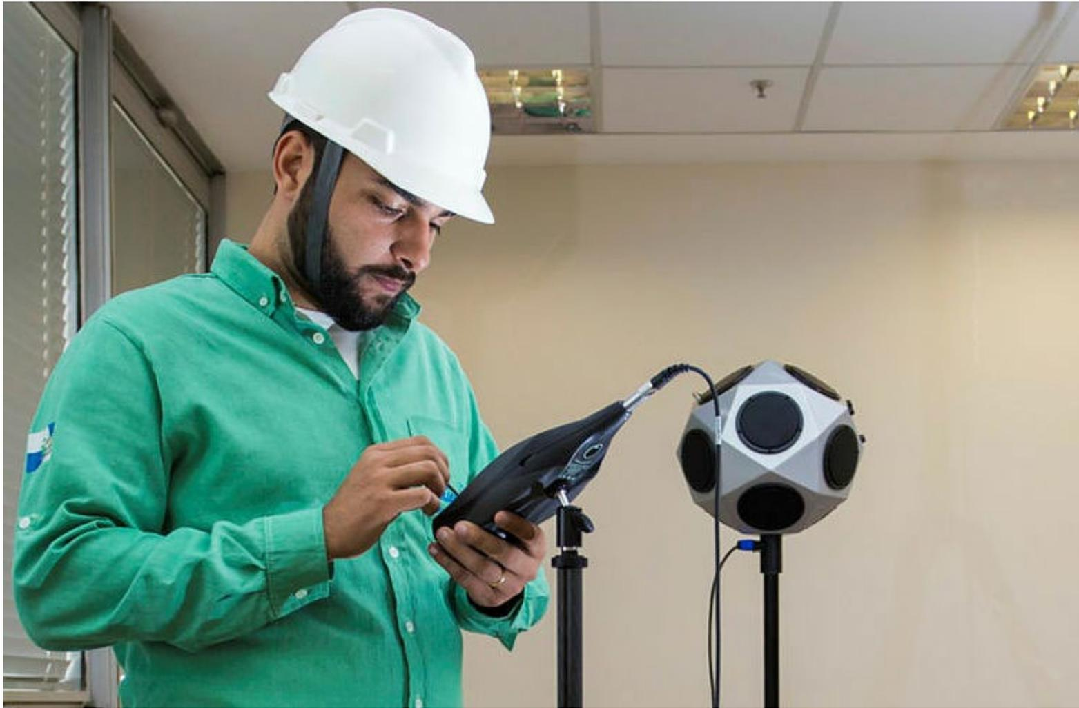
*Laboratório de ensaio de campo acústico adequado à Norma de Desempenho*
